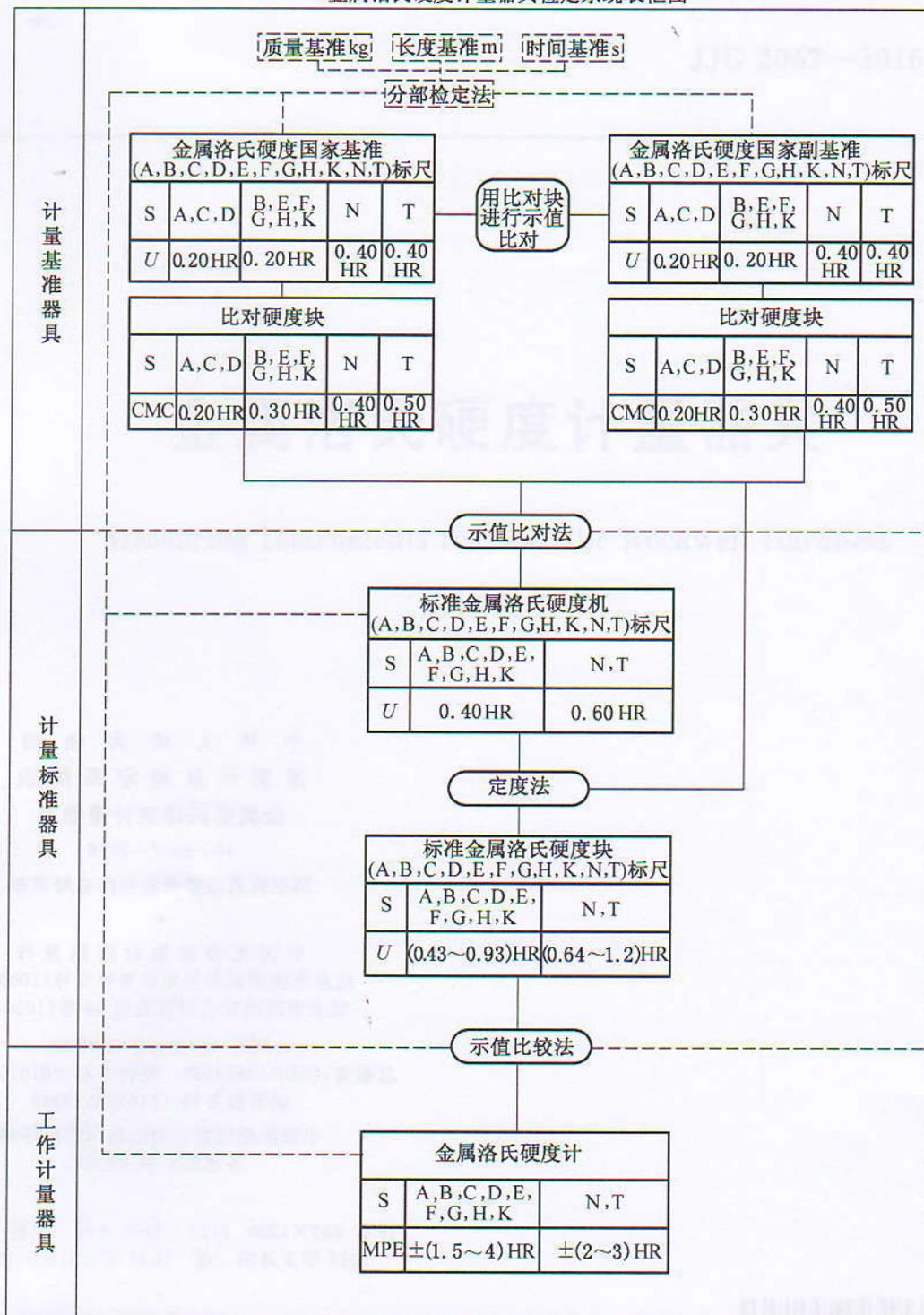
说明: S—硬度标尺; U—扩展不确定度(k=2); CMC—校准和测量能力(k=2); MPE—最大允许误差。
